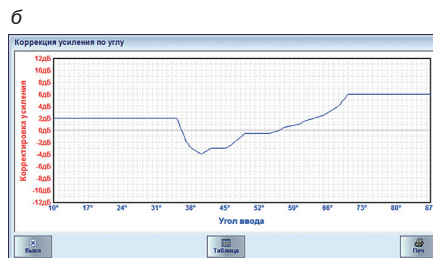
Рис. 11. Стандартный образец с отражателями типа боковое цилиндрическое отверстие (диаметр 2 мм) (а) и соответствующая кривая компенсации усиления в зависимости от угла ввода (б): при построении кривой ФР-преобразователь перемещается вперёд-назад в плоскости, перпендикулярной оси отверстия, обеспечивая приём эхо-сигналов под различными углами однократно отражённым лучом, и амплитуда максимального эхо-сигнала корректируется под соответствующий уровень кривой DAC для каждого угла ввода
