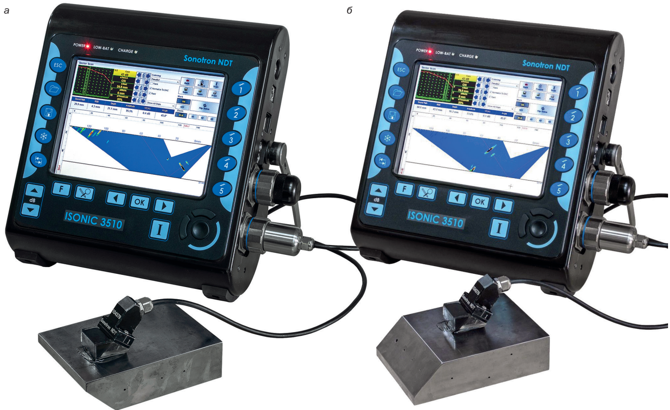
Рис. 5. Прозвучивание образца с плоскодонным отражателем (диск диаметром 2мм) способом секторного сканирования: ФР-преобразователь перемещается вперёд-назад в плоскости, совпадающей с центром отражателя, обеспечивая озвучивание под различными углами прямым (а) и однократно отражённым (б) лучом
