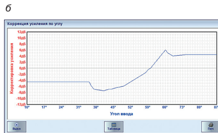
Рис. 5. Прозвучивание образца с плоскодонным отражателем (диск диаметром 2мм) способом секторного сканирования: ФР-преобразователь перемещается вперёд-назад в плоскости, совпадающей с центром отражателя, обеспечивая озвучивание под различными углами прямым (а) и однократно отражённым (б) лучом
