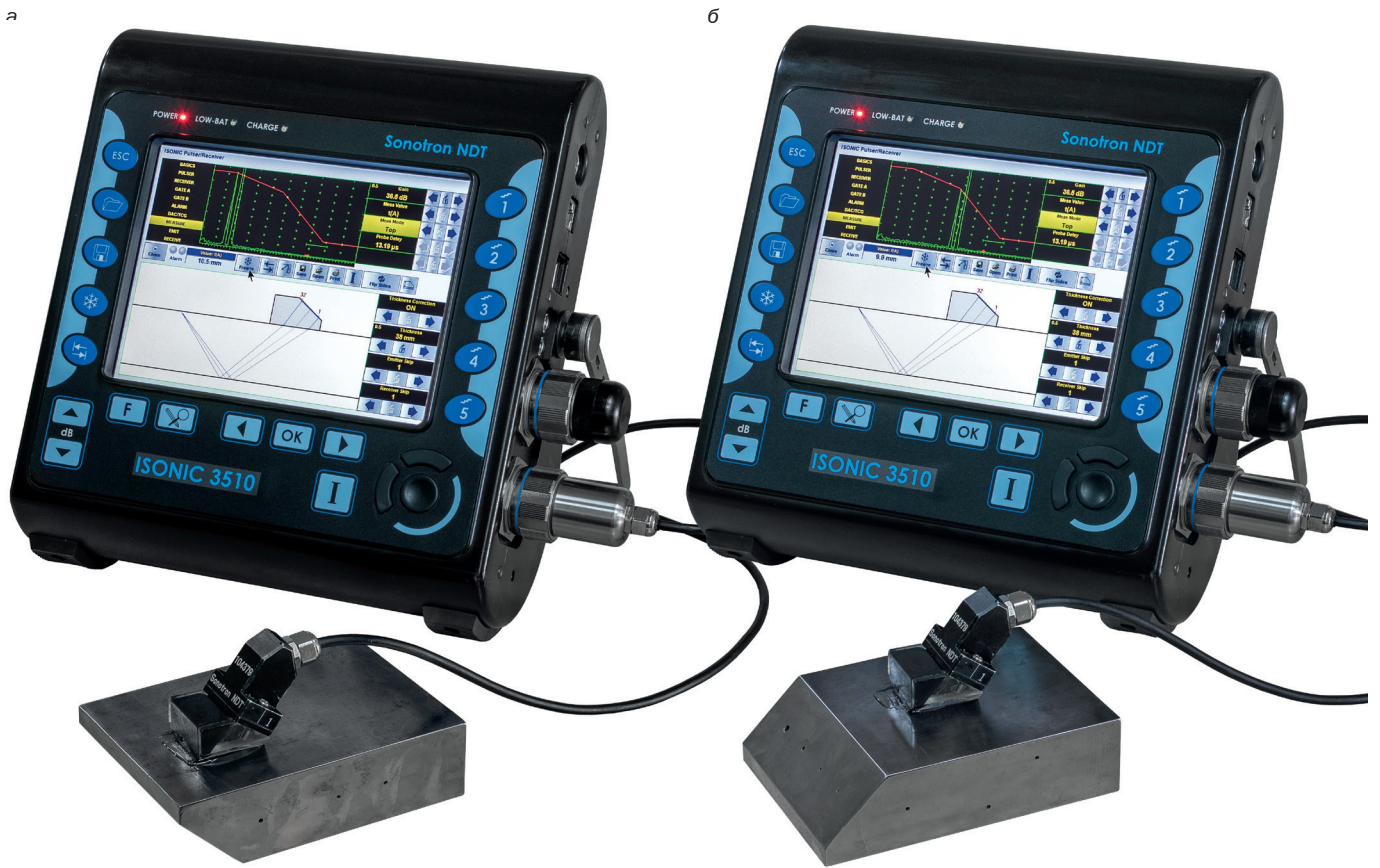
Рис. 3. Построение DAC по плоскодонному отражателю (диск диаметром 2 мм): обнаружение отражателя прямым (а) и однократно отражённым (б) лучом при оптимальном угле ввода, соответствующем лучу, перпендикулярному плоскости отражателя и проходящему через его центр
