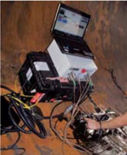
Рис. 5. Механизированный контроль сварного шва толщиной 100 мм по технологии MULTIGROUP AUT
