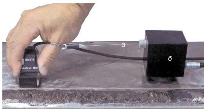
Рис. 2. Датчик координаты, основанный на измерении длины тонкого троса (а), вытянутого из неподвижного основания (б)
