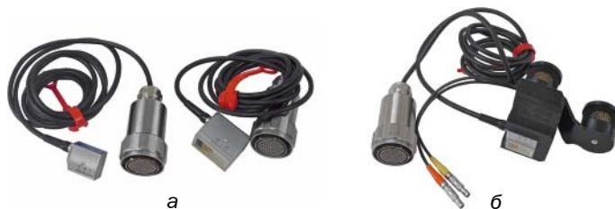
Рис. 3. Монолитные ФР-преобразователи в стандартных корпусах серий MWB и SWB (а) и держатель ФР-преобразователя, оснащенный излучателями ультразвука в воздухе (б)
