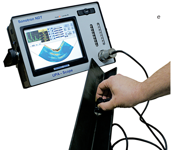
Рис. 7. Иллюстрация контроля гибов композитных деталей современного авиалайнера
