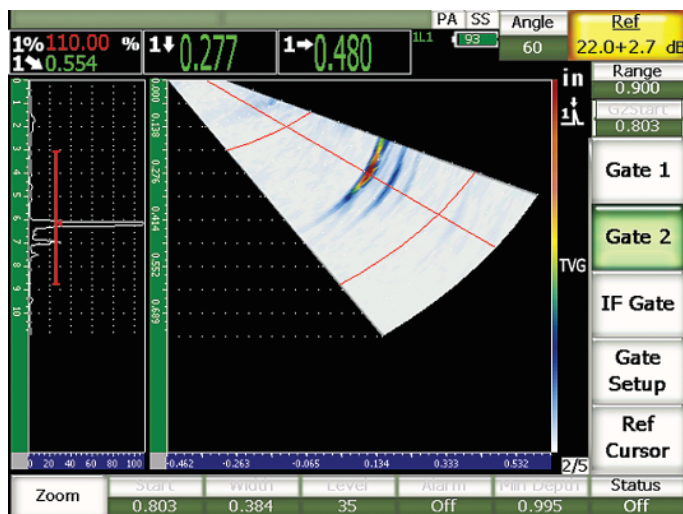
Рис. 3. Типичное В-скан изображение, получаемое способом качающегося луча на экране большинства ФР-дефектоскопов (его также называют S-скан)
