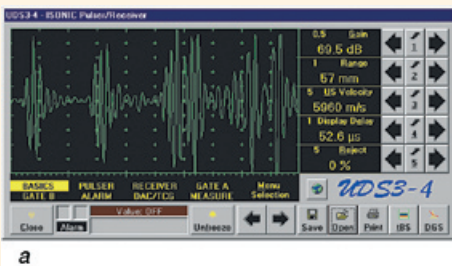
Рис. 9. Пачка импульсов на приемном преобразователе при реализации технологии CHIME (расстояние между преобразователями 32 см, толщина стенки 20 мм) продольной волн соответственно
