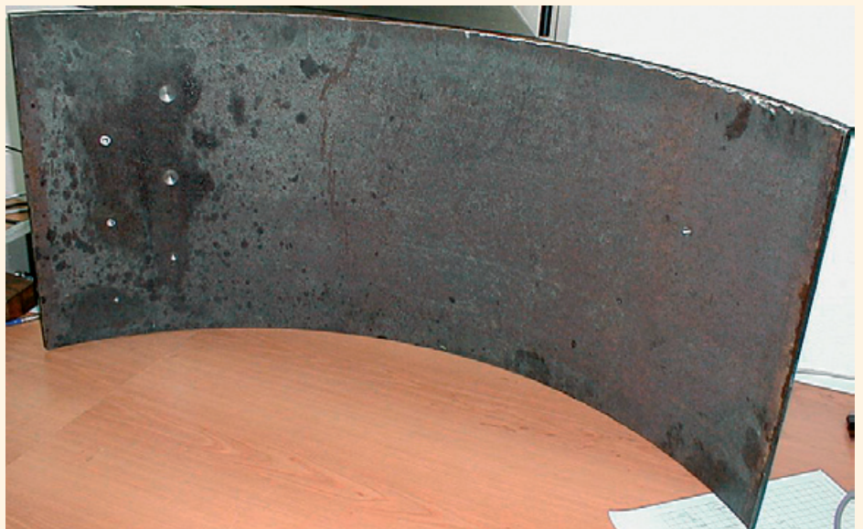
Рис. 6. Образец, используемый для настройки чувствительности при контроле подземных цилиндрических резервуаров для хранения сжиженного газа (внизу) и процесс сканирования резервуара (вверху справа)
