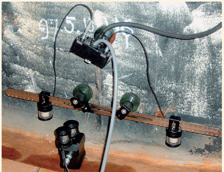
Рис. 4. Местоположение и разворот на выступе опорной плиты преобразователя LRGWI, оснащенного двумя излучателями ультразвука в воздух, отслеживаются двумя приемниками, расположенными непосредственно на стенке резервуара
