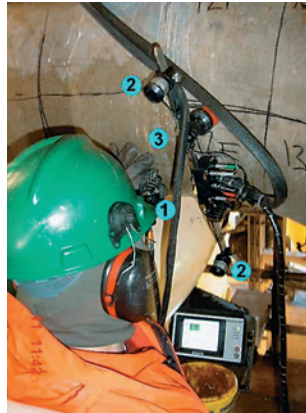
Рис. 1. Акустическая локация: 1, 2 – соответственно излучатель и приемники ультразвуковых волн; 3 – объект контроля
